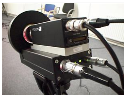
Ryc. 2.3. Kamera systemu Vicon 250 (Vicon Manual)
